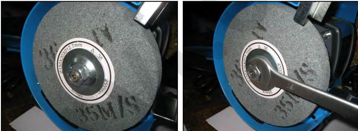
Figura 18 – Dado e flangia di fissaggio della mola.
