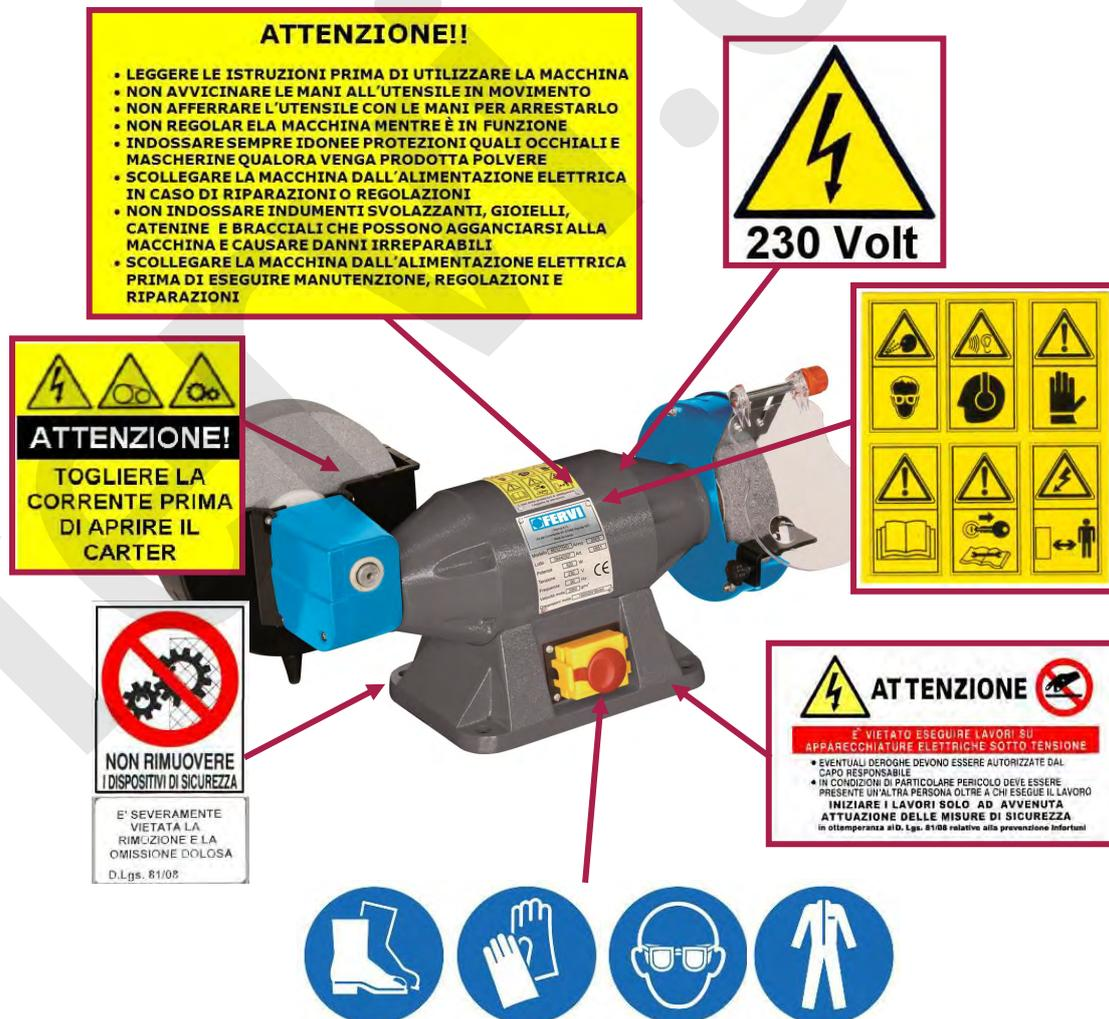
Figura 3 - Pittogrammi di segnalazione ed attenzione.
