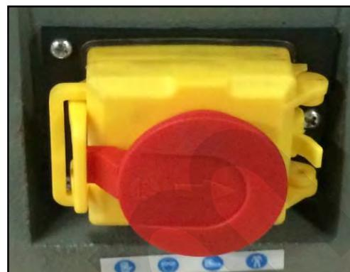
Figura 13 – Calottina di arresto di emergenza.
