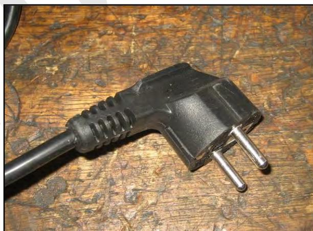
Figura 9 – Particolare spina di alimentazione.
