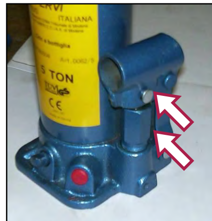
Figura 12 – Perna e cerniere della pompa.
