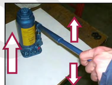
Figura 9 – Pompare per il sollevamento.
