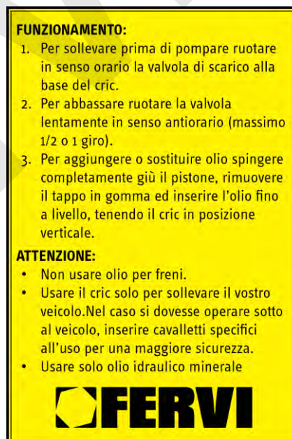
Figura 5 – Dettaglio pittogramma sul retro del cric.
